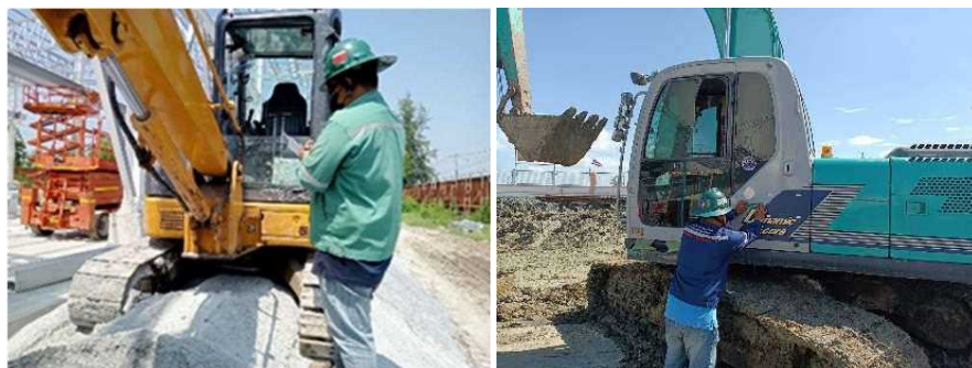
รูปที่ ค-69 ตรวจสอบสภาพรถขุดก่อนเริ่มปฏิบัติงาน
