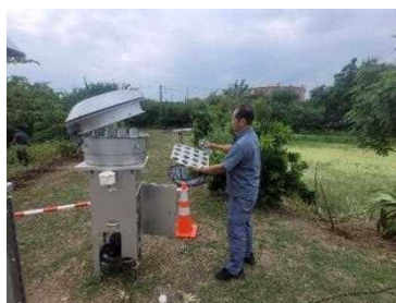
รูปที่ ค-92 การตรวจวัดคุณภาพอากาศในบรรยากาศโดยทั่วไป บริเวณกลุ่มบ้านพักอาศัยใกล้พื้นที่ก่อสร้างสถานี MR ระหว่างวันที่ 20-24 ตุลาคม 2565
