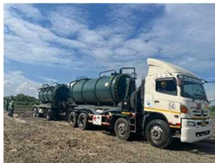
รูปที่ ค-54 จัดจ้างหน่วยงานที่ได้รับอนุญาตฯ รับโคลนโซเดียมเบนโทไนท์ไปกำจัด
