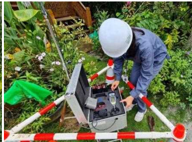
รูปที่ ค-93 การตรวจวัดระดับเสียงโดยทั่วไป บริเวณกลุ่มบ้านพักอาศัยใกล้พื้นที่ก่อสร้างสถานี MR ระหว่างวันที่ 22-26 กันยายน 2565
