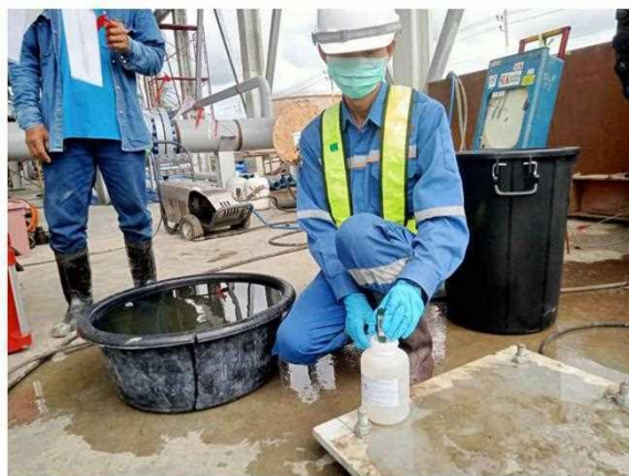
รูปที่ ง-3 รูปแสดงการตรวจวัดคุณภาพน้ำทิ้งจากการทดสอบท่อด้วยวิธีทางชลสถิต ระหว่างเดือนตุลาคม-พฤศจิกายน
