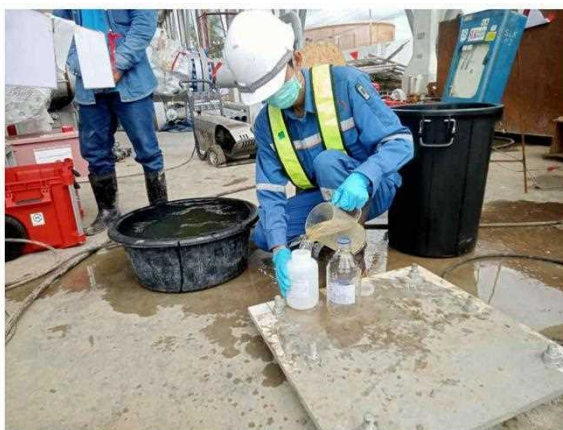
รูปที่ ง-3 รูปแสดงการตรวจวัดคุณภาพน้ำทิ้งจากการทดสอบท่อด้วยวิธีทางชลสถิต ระหว่างเดือนตุลาคม-พฤศจิกายน
